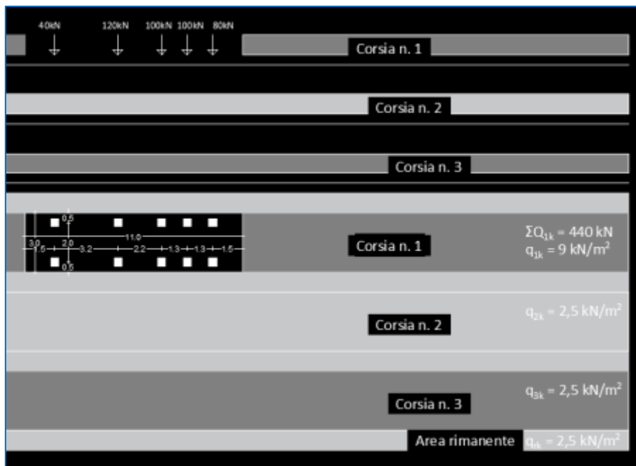
Figura 14 – Schema di carico minimo in assenza di restrizioni geometriche all'uso del ponte (3 corsie di calcolo)
